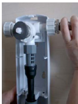
7. Anslut en slang för vattenförsörjning med en innerdiameter på minst 13 mm till vattenintaget (ett tryck på minst 25 PSI krävs när vattnet är på för att enheten ska fungera korrekt.
